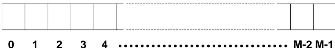
程序运行中构造、使用、处理的对象，都在这种线性结构里安排位置
